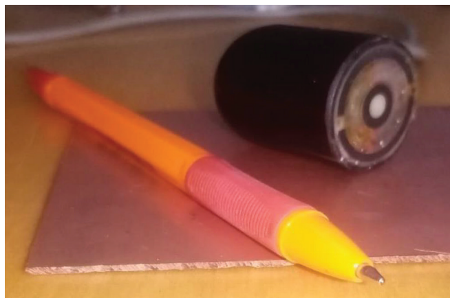
Рис. 2. Внешний вид вихретокового датчика и контролируемого образца
