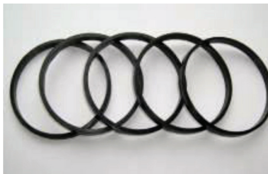
Рис. 1. Кольцевые образцы базальтопластика
