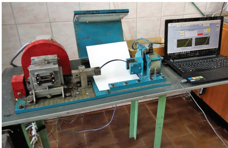
Рис. 5. Процесс испытаний образцов базальтопластика на продольный изгиб
