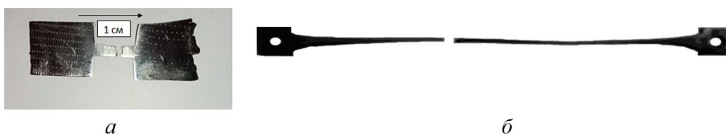
Рис. 1. Образец сплава 47ХНМ толщиной 0,5 мм: а — после отжига и растяжения при комнатной температуре; б — после сверхпластической деформации при 950 °С
