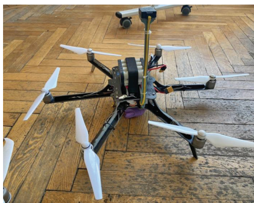
Рис. 1. Фото и общая конфигурация гексакоптеров: 1) корпус; 2) полетный контроллер; 3) мотор; 4) пластиковый пропеллер; 5) регулятор мотора; 6) GPS-Glonass модуль со встроенным компасом и антенной; 7) курсовая, поворотная видеокамера; 8) видеопередатчик с антенной; 9) приемник управления с антенной; 10) модуль WiFi; 11) сервоприводы; 12) блок аккумуляторной батареи; 13) сбрасывающий механизм
