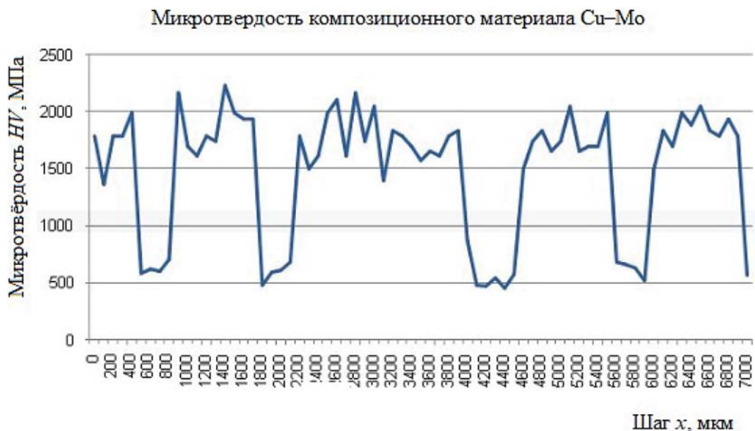
Рис. 4. Данные о микротвердости HV (МПа) компонентов КМ и переходных зон между медью и молибденом
