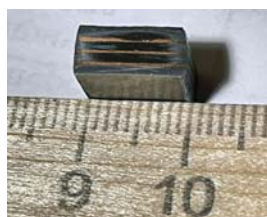
Рис. 2. Общий вид опытных образцов системы Cu-Mo, полученных методом сварки взрывом
